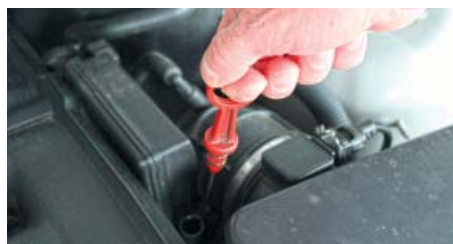
Spegnere il motore ed aspettare che l'olio scenda dai condotti nella vaschetta prima di controllare il livello.
