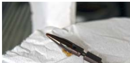
Il livello dell'olio deve essere compreso fra il minimo e il massimo. La mancanza o un eccesso di olio può compromettere il motore.
